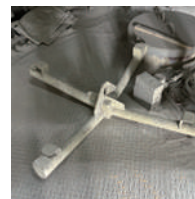
新增十字吊具，使之太空包吊耳分散應力(斜拉力改成垂直立)
